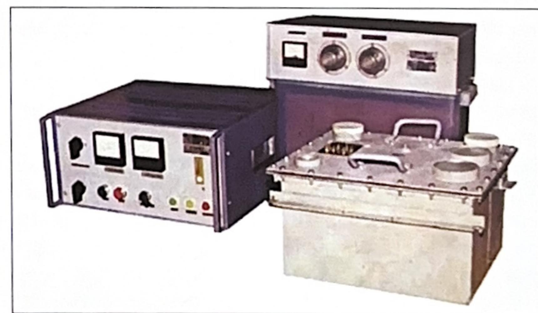
Рис. 5. Оборудование для электроразрядной очистки.
