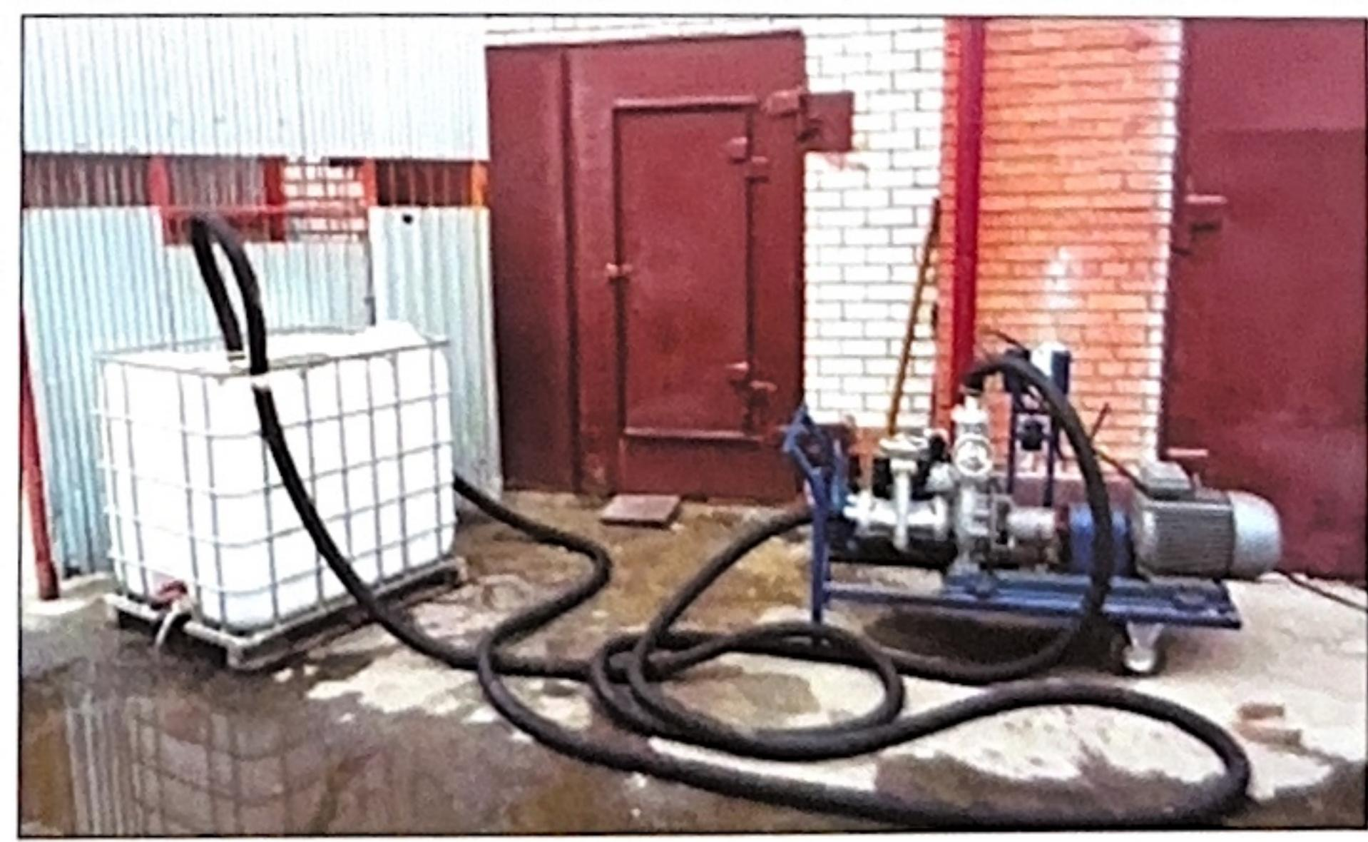
Рис. 3. Установка для промывки промышленных котлов.
