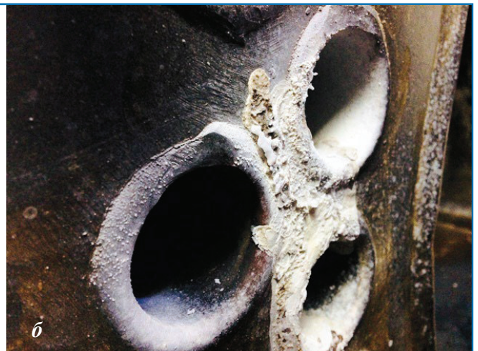
Рисунок 1. Повреждения поверхностей жаротрубного котла, обнаруженные из-за накипи: а – котёл Buderys , выведенный в ремонт, б – течь на передней трубной доске котла ICI CALDAIE
