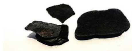
Рис. 2. Образцы накипи из котла LNE Compact 12.0
