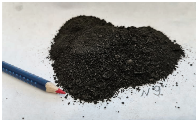
Рис. 3. Накипь из водогрейного котла
