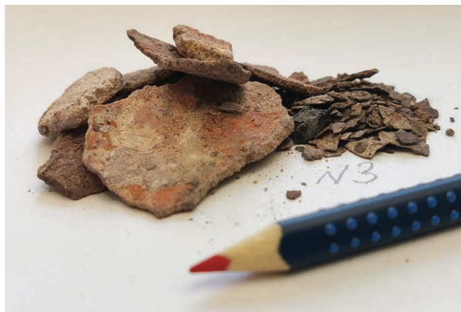
Рис. 4. Накипь из парового котла
